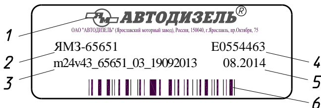
Рисунок 16 – Наклейка на ЭБУ М240 55.3763-01 двигателя ЯМЗ-65651
